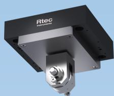
高荷重用歪みゲージロードセル
